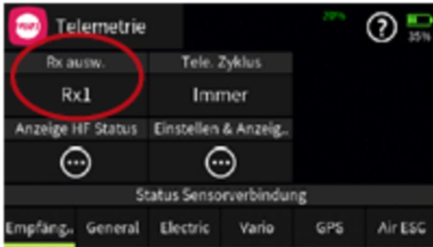
Bis zu vier Empfänger können im Untermenü „HF Konfig.“ des Basis-Menüs an einen Modellspeicher gebunden werden. Eine Telemetrie-Verbindung kann jedoch immer
