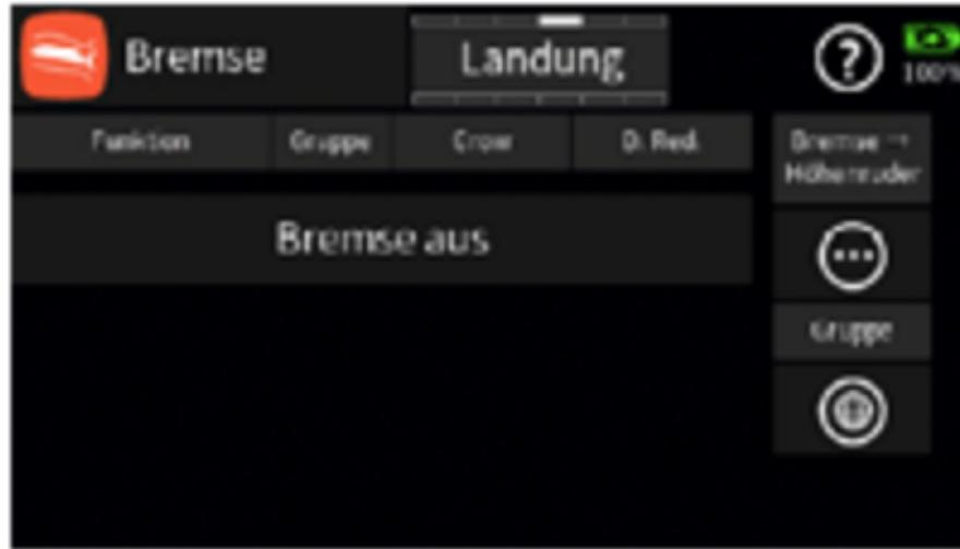
Nutzbare ist in diesem Fall nur die Option „Bremse => HR“ auf der durch Antippen des Symbols unter „Bremse => Höhenruder“ aufrufbaren Detailseite. Alle anderen Einstellmöglichkeiten sind entweder ausgeblendet oder blo-
