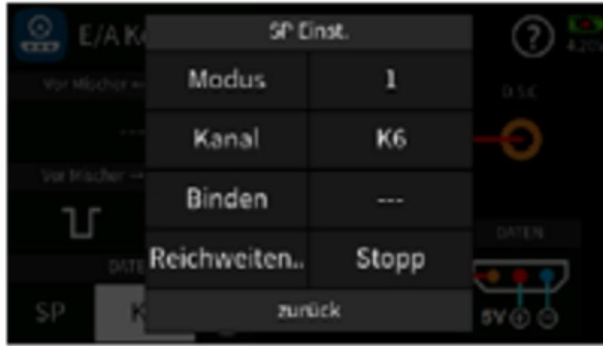
In diesem ist der „Modus“ sowie die Kanalanzahl einzustellen. Des Weiteren kann über dieses Einstellmenü der Binde-Vorgang sowie ein Reichweitentest ausgelöst werden.
